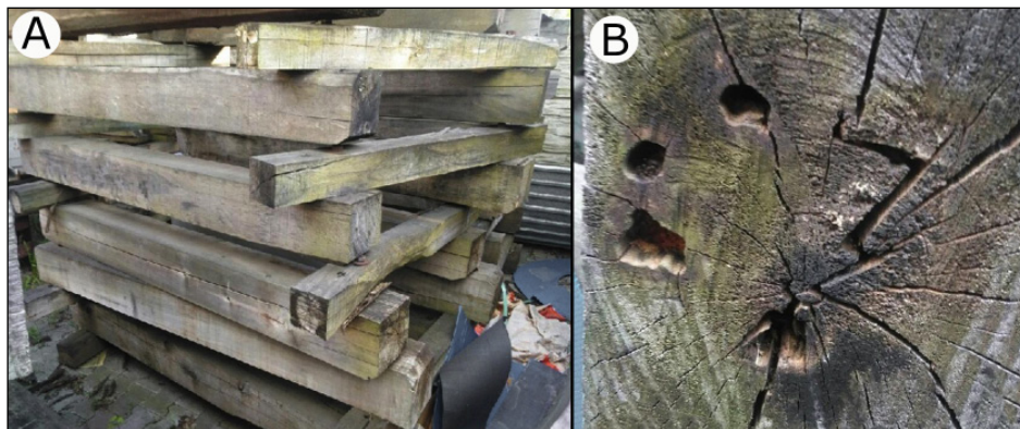
Ryc. 1. Legary z licznymi otworami wylotowymi Aegosoma scabricorne (SCOPOLI, 1763) (A) i otwory wylotowe (B) (fot. M. Waligóra).
